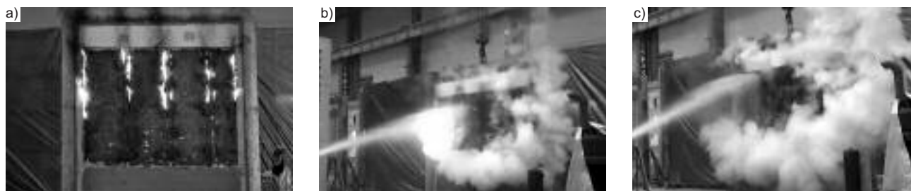
Badanie strumieniem wody: a – element próbny po badaniu odporności ogniowej (strona nagrzewana); b – pierwszy kontakt elementu próbnego ze strumieniem wody; c – element próbny podczas gaszenia [Fot. archiwum ITB] Hose stream test: a – test specimen after fire resistance test (exposed surface); b – exposed surface in first contact with hose stream; c – test specimen during the hose stream test
