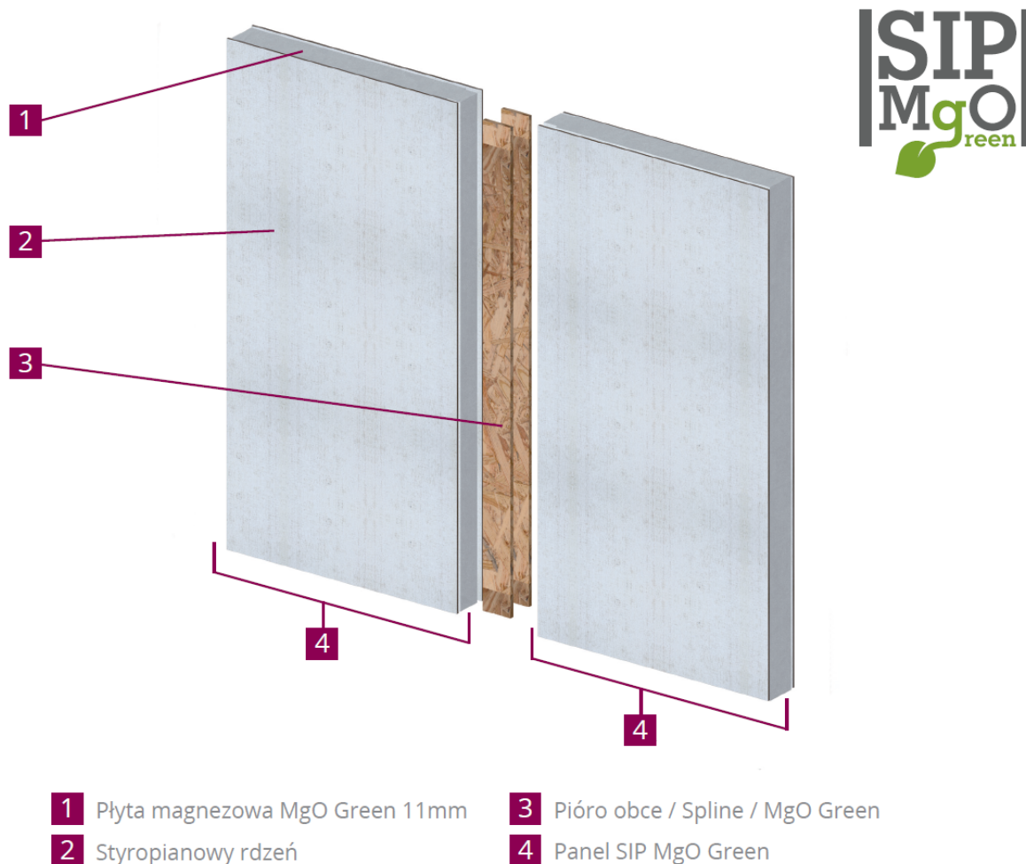
Rys. 2: Połączenia pomiędzy panelami kompozytowymi SIP MgO Green na pióro obce
